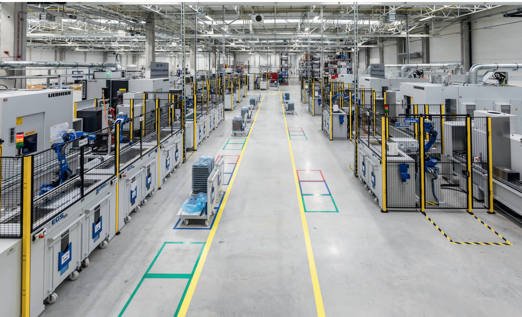
2 Im Werk in Nowa Ruda stehen drei Wälzfräs- und sechs Wälzschleifmaschinen von Liebherr © Liebherr Verzahntechnik
